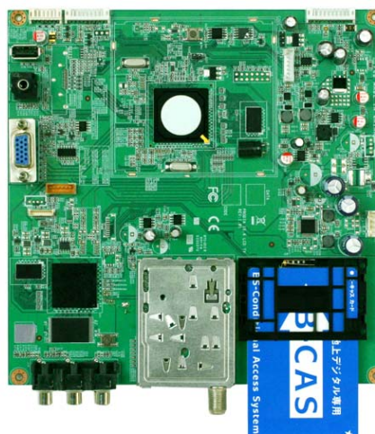
デジタルとアナログがワンボード化された自社設計の内部ボード
